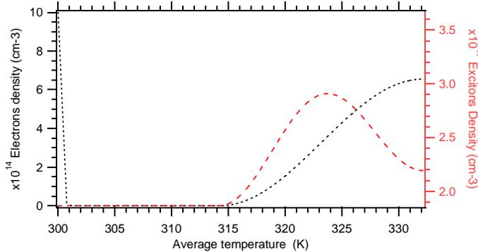
**Figure 2:** Profiles of the excess minority carrier density depending on the average temperature  $N_A=10^{15} \text{ cm}^{-3}$ ;  $N_D=10^{19} \text{ cm}^{-3}$ ;  $n_i=1,45 \cdot 10^{10} \text{ cm}^{-3}$ ;  $n_{\text{mott}}=1,0310^{18} \text{ cm}^{-3}$ ;  $bs=10^{+1} \text{ cm s}^{-1}$ ;  $\text{Fact\_ch}=5 \times 10^{-2}$ ;  $\text{Se}=\text{Sx}=3 \times 10^{+3} \text{ cm s}^{-1}$ ;  $F_0=10$
